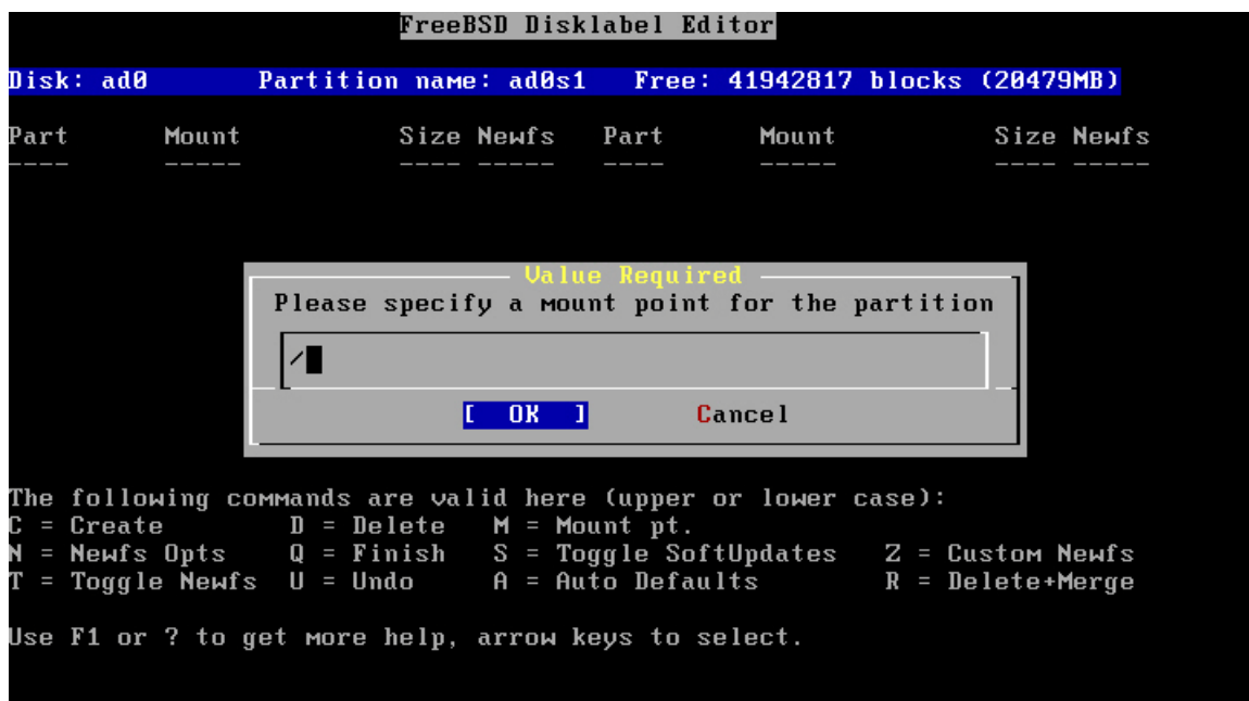
图 2.1.10 选择挂载点，分别输入 /、/tmp、/home、/usr、/var、/data。
