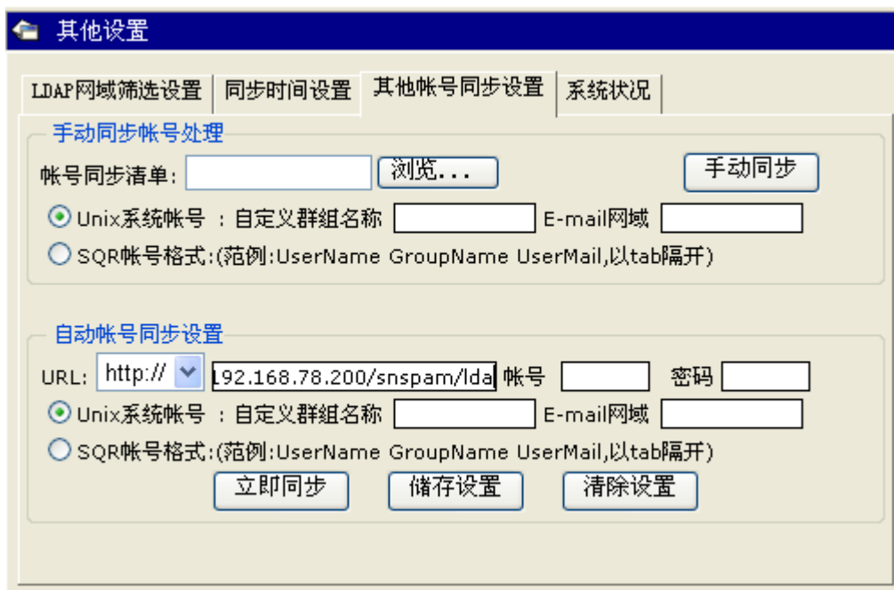
图 4.3.3.7 帐号同步设置除了能让您由标准的 LDAP 服务器进行帐号同步外，也支持标准类 Unix 系统帐号文件，及 Mail Archiving Expert 支持帐号格式同步。
